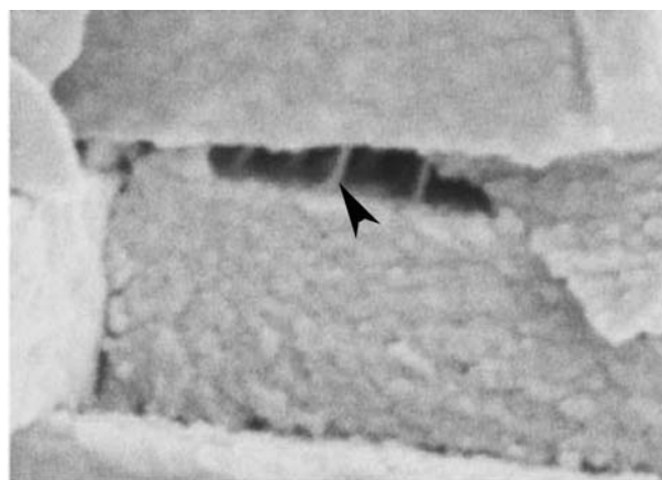
Abbildung 3. REM-Aufnahme von gebrochenem Perlmutter, die verbindende organische Matrix zwischen zwei Aragonitkristallen zeigend (schwarzer Pfeil). Abdruck mit Genehmigung aus Lit. [31], Copyright 1998 Macmillan Publishers Ltd.
